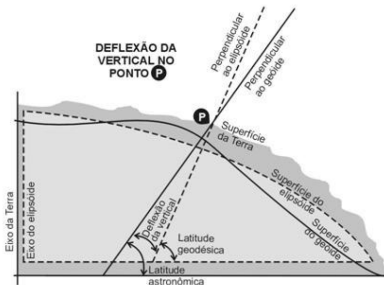
Figura I.1.15 – Representações da superfície da Terra: o elipsóide de revolução e o geóide, com suas respectivas perpendiculares em um dado ponto.
